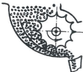
Рис.36. Схема работы катушки
